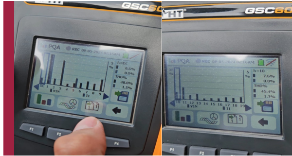
Figura 24. Imagen del equipo y la presencia de múltiples armónicos en las mediciones del pozo Directo 25.
